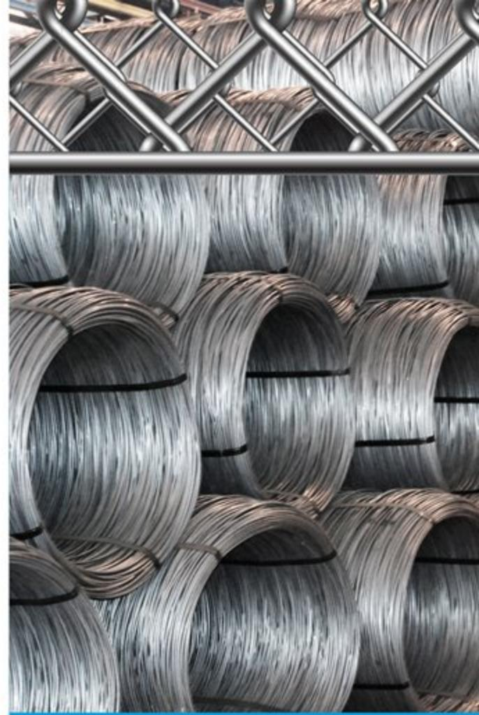
เหล็กลวด (Wire rod) คือ ผลิตภัณฑ์เหล็กทรงแท่งที่ผลิตมาจากการรีดร้อนเหล็กแท่ง (billet) เหล็กลวดเป็นวัตถุดิบของกลุ่มอุตสาหกรรมเหล็กลวดที่ผลิตเป็นอุปกรณ์เครื่องมือใช้สอยต่าง ๆ ที่ใช้ในการประกอบธุรกิจ อาชีพการงาน และใช้ในชีวิตประจำวัน เหล็กลวดแม้เส้นเล็กแต่ถ้ามีความสำคัญไม่ยิ่งหย่อนกว่าเหล็กขนาดใหญ่ ดังนั้นเมื่อเลือกใช้เหล็กลวดที่ดีมีมาตรฐานจึงเท่ากับเป็นรากฐานของการผลิตสินค้าต่อเนื่องที่ได้มาตรฐานและคุณภาพสูง
